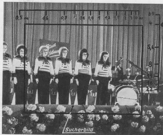
Abb. 10: Bildmaske eines Mattscheibensuchers der Fernseh G. m. b. H.
