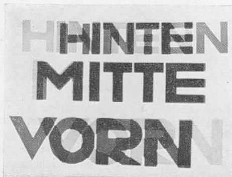
Abb. 4: Meßsucherbild mit einem Meßwinkel von  $\varphi \cong 44^\circ$ .
