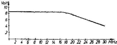
Abb. 19: Frequenzgang des Verstärkers nach Abb. 17, Ausgangsbelastung 10 pF.
