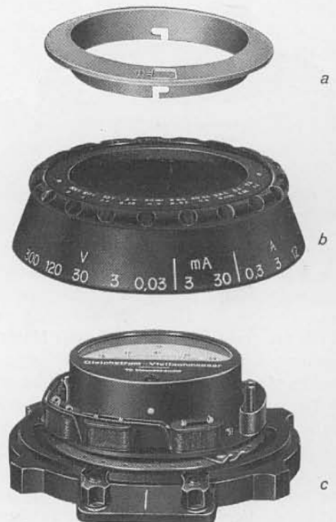
Bild 2a, b, c. AEG-Gleichstrom-Vielfachmesser, zerlegt.
