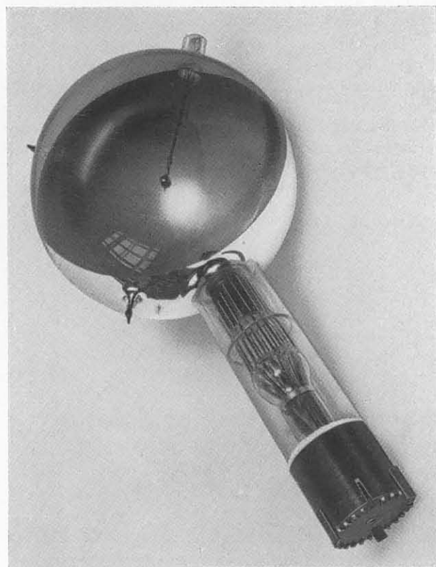
Abb. 1a: Photozelle mit Sekundärelektronenverstärker für Gegensehanlagen 1938.
